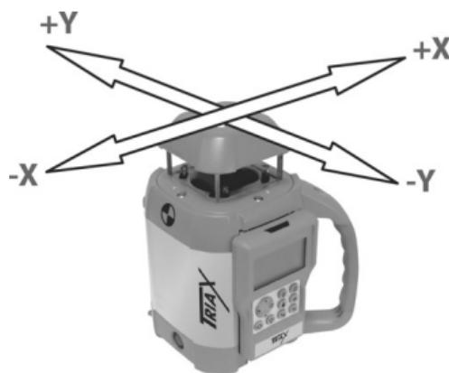
Die Markierungen für die beiden Horizontalachsen (X und Y) befinden sich am Kopf des Instruments. Die Enden der Achsen werden hier mit + oder – bezeichnet um die verschiedenen Seiten der Achsen zu kennzeichnen.
