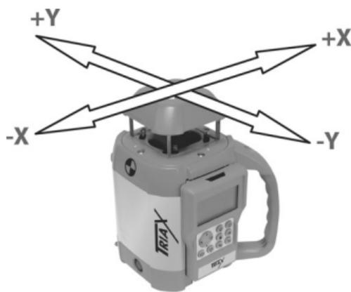
Beide Enden jeder Achse müssen zur Kalibrierung kontrolliert werden. Wenn nötig, können die Achsen mittels der Fernbedienung kalibriert werden. Bei Schwierigkeiten empfehlen wir Ihnen, den Laser in einer Sokkia Servicestation fachmännisch kalibrieren zu lassen.
